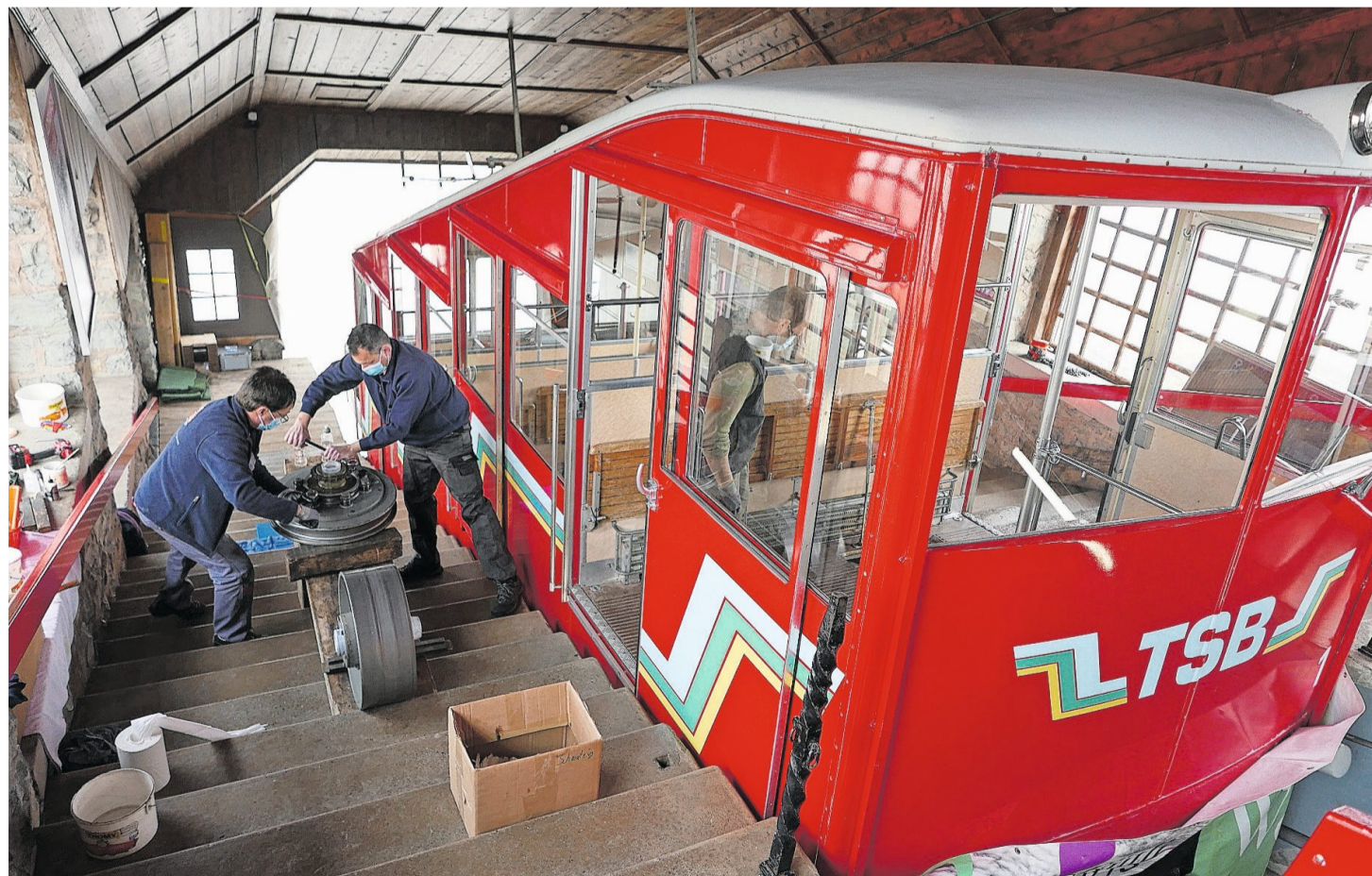
Mitarbeiter bei der Kontrolle von Spurrad und Walzrad der Standseilbahn.
